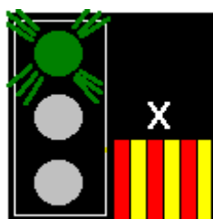
Fig. 28 LIBER cu viteza redusă în abateră de cel mult 30 km/h. - o lumină verde care arde clipitor -
