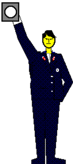
Fig. 115 S-A TERMINAT PROBA FRÂNEI, FRÂNA ESTE ÎN REGULĂ - lanterna cu lumină albă se ține deasupra capului.
