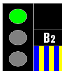
Fig. 8 LIBER cu viteză stabilită. Semnalul următor este pe liber.
