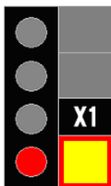
Fig. 68 Reperul semnalelor care permit intrarea pe o secție echipată cu sistem ATC Bombardier.
