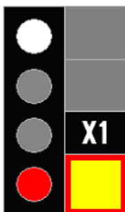
Fig. 60 OPREȘTE fără a depăși semnalul! - o lumină roșie și o lumină alb-lunar-
