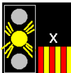
Fig. 22 LIBER cu viteza redusă în abateră sau pe directă, de cel mult 20 km/h, corespunzătoare codului ATP recepționat din cale. - o lumină galbenă care arde clipitor -
