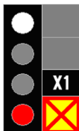
Fig. 52 LIBER cu cel mult viteza indicată de codul ATP recepționat din cale - o lumină roșie și o lumină alb lunar -
