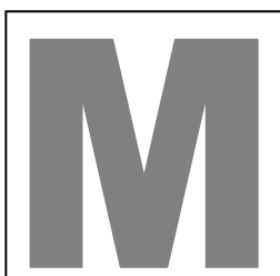
Fig. 102 Lipsă tensiune în șina de contact - șina a 3-a. Litera „M” neiluminată.
