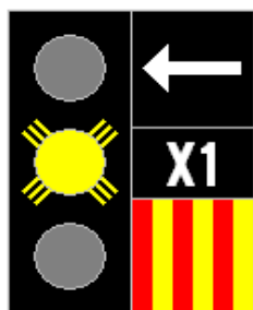
Fig. 50 Semnal cu indicator „circulația pe contrasens”
