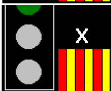
Fig. 3 LIBER cu viteza stabilită. Semnalul următor este pe liber. - o lumină verde -
