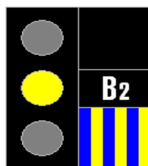
Fig. 7 LIBER cu viteza de cel mult 60 km/h. ATENȚIE! Semnalul următor ordonă oprirea sau permite circulația cu viteza redusă de 20 sau 30 km/h, în abatere.
