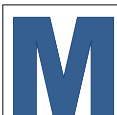
Fig. 101 Prezență tensiune în șina de contact - șina a 3-a. Litera „M” iluminată de culoare albastră.
