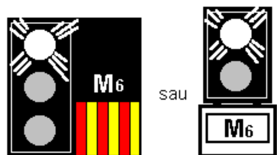
Fig. 11 Manevra permisă dincolo de semnal cu viteza de cel mult 15 km/h. ATENȚIE ! Linia este ocupată.
