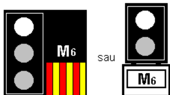
Fig. 10 Manevra permisă dincolo de semnal, pe linie liberă, cu viteza de cel mult 20 km/h.
