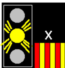
Fig. 4 LIBER cu viteza redusă în abatere de cel mult 20 km/h. - o lumină galbenă care arde clipitor - În cazul semnalului de ieșire, circulația cu viteza redusă se va efectua până la primul indicator de viteză.
