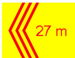
Fig. 93 Indicatorul de început a porțiunii de tunel cu gabarit redus
