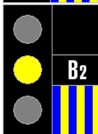
Fig. 42 LIBER cu viteză de cel mult 60 km/h, ATENȚIE! Semnalul următor ordonă oprirea. - o lumină galbenă -
