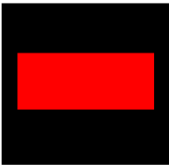
Fig. 82 Trecerea oprită ! S-a terminat linia de circulație - o fantă orizontală cu lumina de culoare roșie –
