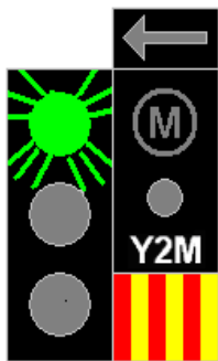
Fig. 40 LIBER cu viteza redusă în abateră de cel mult 30 km/h. - o lumină verde care arde clipitor -
