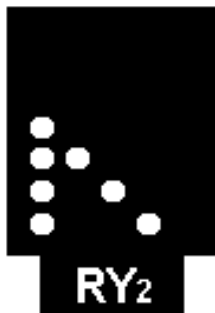
Fig. 13 Semnalul următor este pe liber cu viteza de 60 km/h sau viteza redusă
