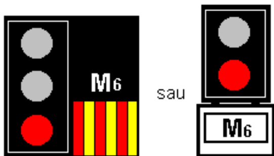
Fig. 9 OPREȘTE fără a depăși semnalul. Manevra interzisă dincolo de semnal:
