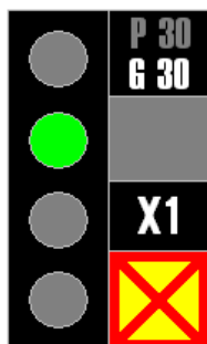
Fig. 72 Indicatoare combinate de direcție și viteză pentru o stație din care se ramifică două direcții de mers destinate circulației trenurilor cu călători, din care unul este aprins corespunzător direcției în care s-a executat parcursul, celălalt aferent celei de-a doua direcții de mers, fiind stins.
