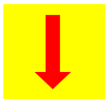
Fig. 85 Indicator „distanța până la semnalul următor mai mică de 200m”
